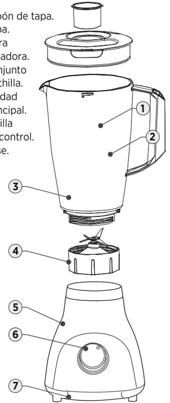
Si fuera necesario, puede extraer el conjunto cuchilla para su limpieza. Gírelo -ver imagen-, y proceda a lavar mediante agua corriente y jabón: conjunto cuchilla, jarra, tapa, y tapón medidor.
